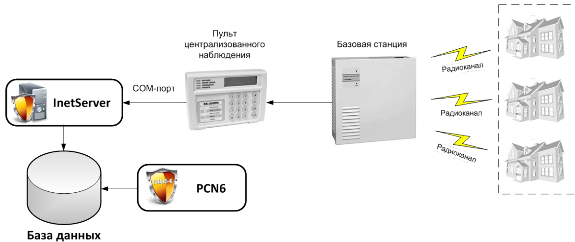
Рис. 3.3.18.1. Принцип работы потока «Альтоника RS-201PN и RS-202PN»
