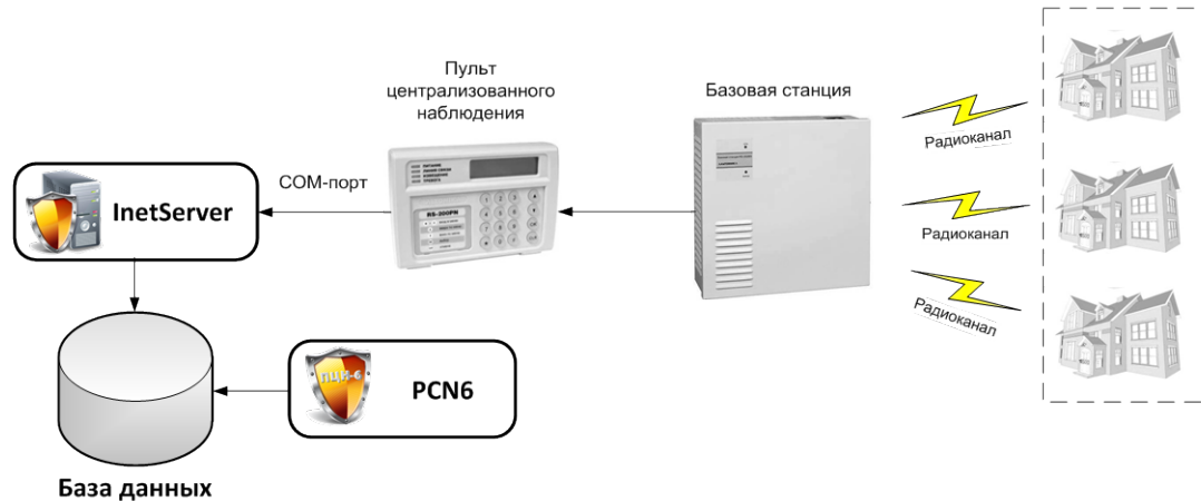
Рис. 3.3.18.1. Принцип работы потока «Альтоника RS-200PN»
