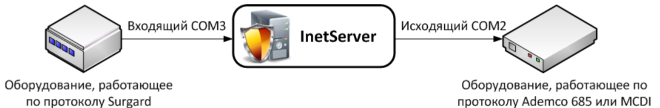
Рис. 3.3.3.1. Принцип работы потока «Преобразование протокола DSC Surgard»
