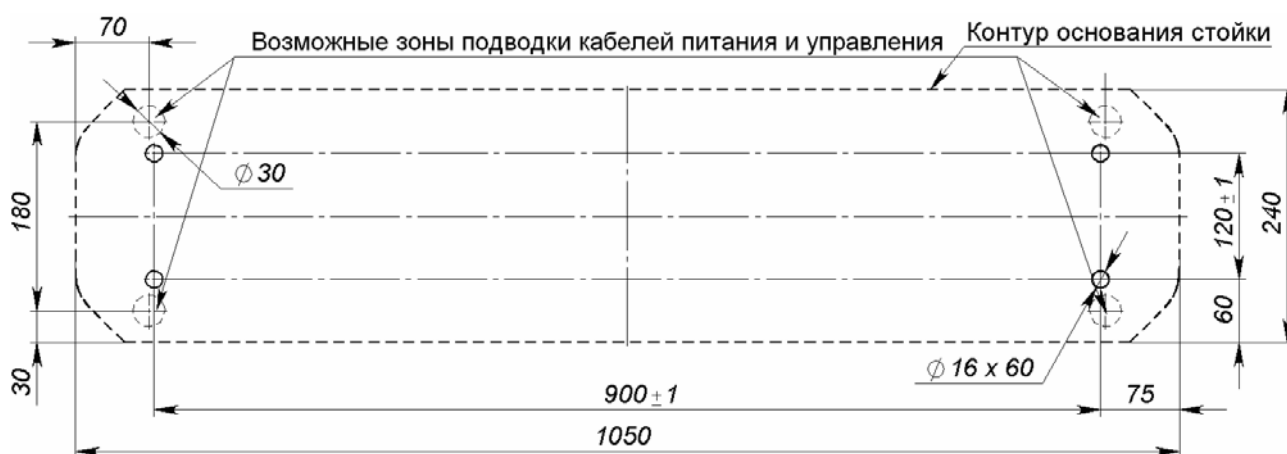
Рисунок 9 Схема разметки для установки стойки турникета
