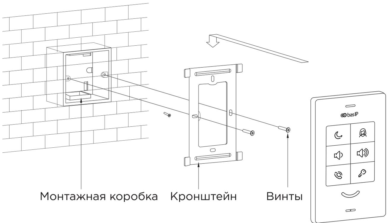
Перед установкой аудиоустройства с трубкой SP-AU необходимо прикрутить крепление для трубки на задней стороне как показано на схеме ниже:
