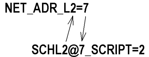
Рис. 2.3 Связь между номером входа, номером линии и сетевым адресом
