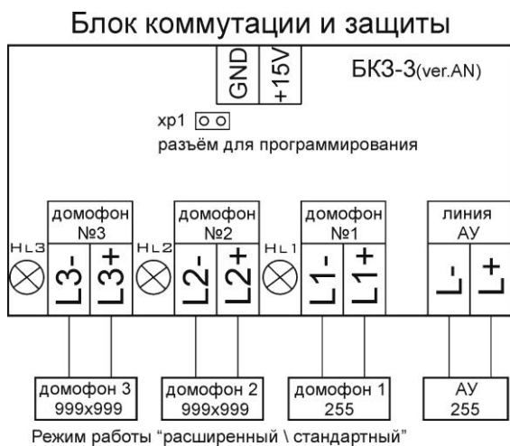
Рис.5 Подключение к блоку коммутации и защиты БК3-АН
