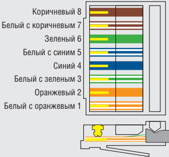
Рисунок 6. Обжимка кабеля UTP
