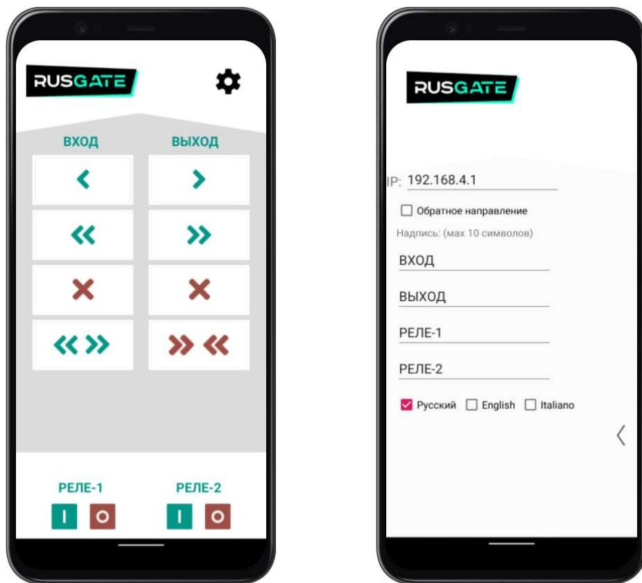
С помощью первых трех рядов кнопок (1-6 кнопки) приложения RC\_Plate турникет открывается на одиночный или свободный проход в нужную сторону, или блокируется проход в нужную сторону.
