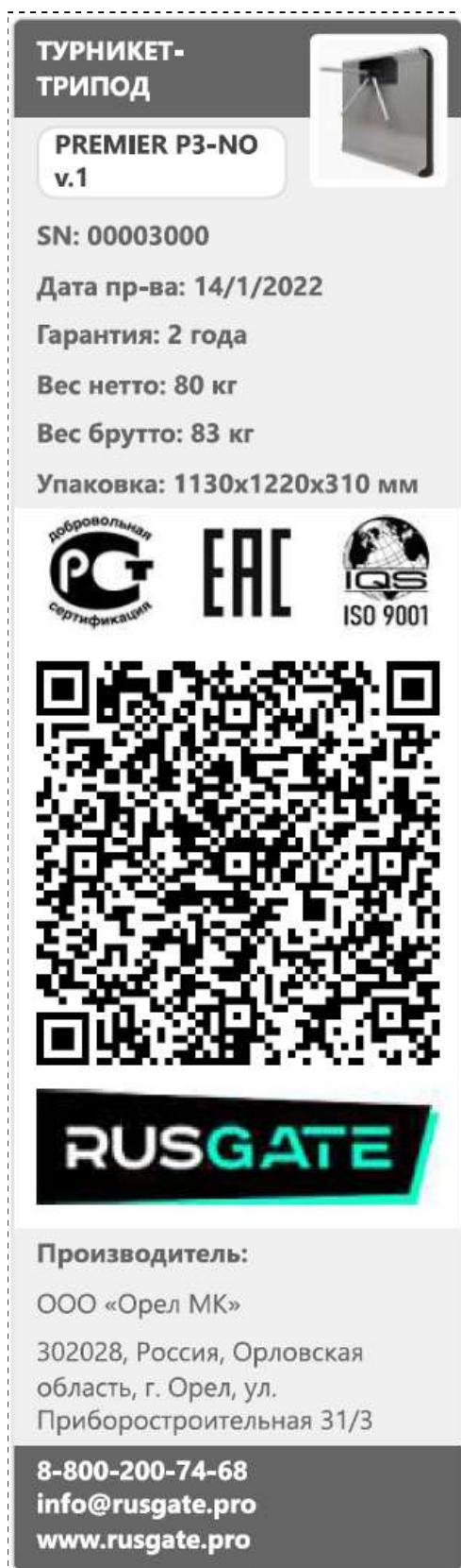
Турникеты имеют физическую маркировку в виде ламинированных влагостойких этикеток, расположенных на лицевой части механизма под Передним кожухом. Чтобы считать информацию с этикетки необходимо демонтировать Передний кожух п.2, предварительно отсоединив преграждающие планки. Этикетка имеет следующий вид:
