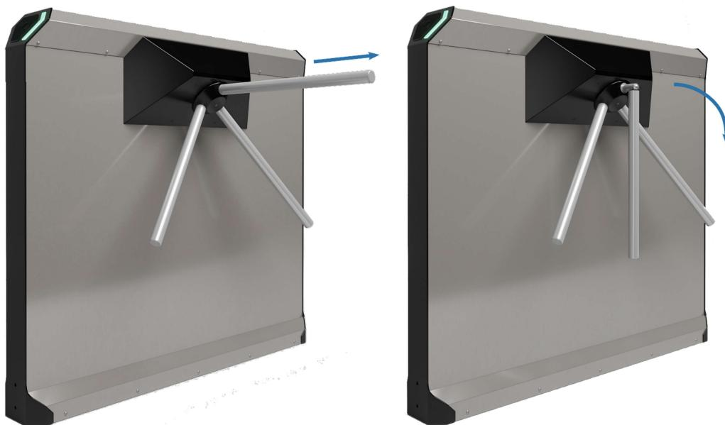
В чрезвычайной ситуации аварийным выходом могут служить преграждающие планки «Антиталика». Конструкция этих планок позволяет быстро организовать свободный проход без применения специальных ключей или инструментов. Для этого необходимо потянуть преграждающую планку, перекрывающую зону прохода, в осевом направлении в сторону от стойки турникета, до высвобождения механизма поворота планки, и затем сложить планку, опустив ее вниз.
