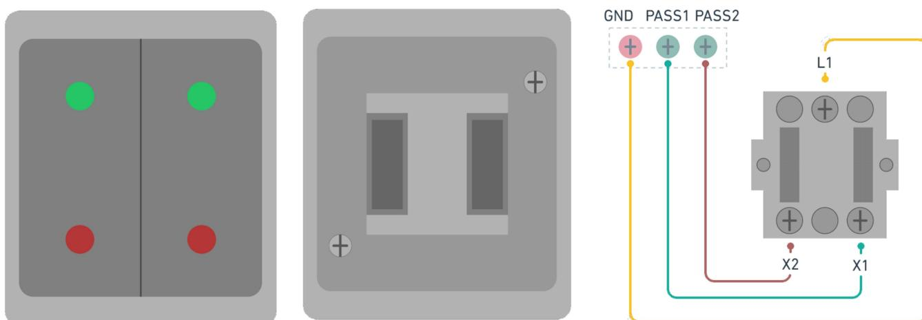
Снимите изоляцию с обеих сторон кабеля приблизительно на 60 мм. Зачистите концы каждого из проводов кабеля: которые идут на выключатель на длину 8-10 мм, которые идут на турникет на длину 5-6 мм. Скрутите желтый и коричневый провода между собой с обоих концов кабеля. Загните вдвое очищенные от изоляции концы проводов, которые идут на выключатель.
