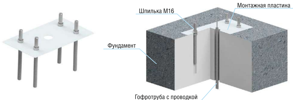
Рисунок 7.2.1 Устройство фундамента с монтажным комплектом
