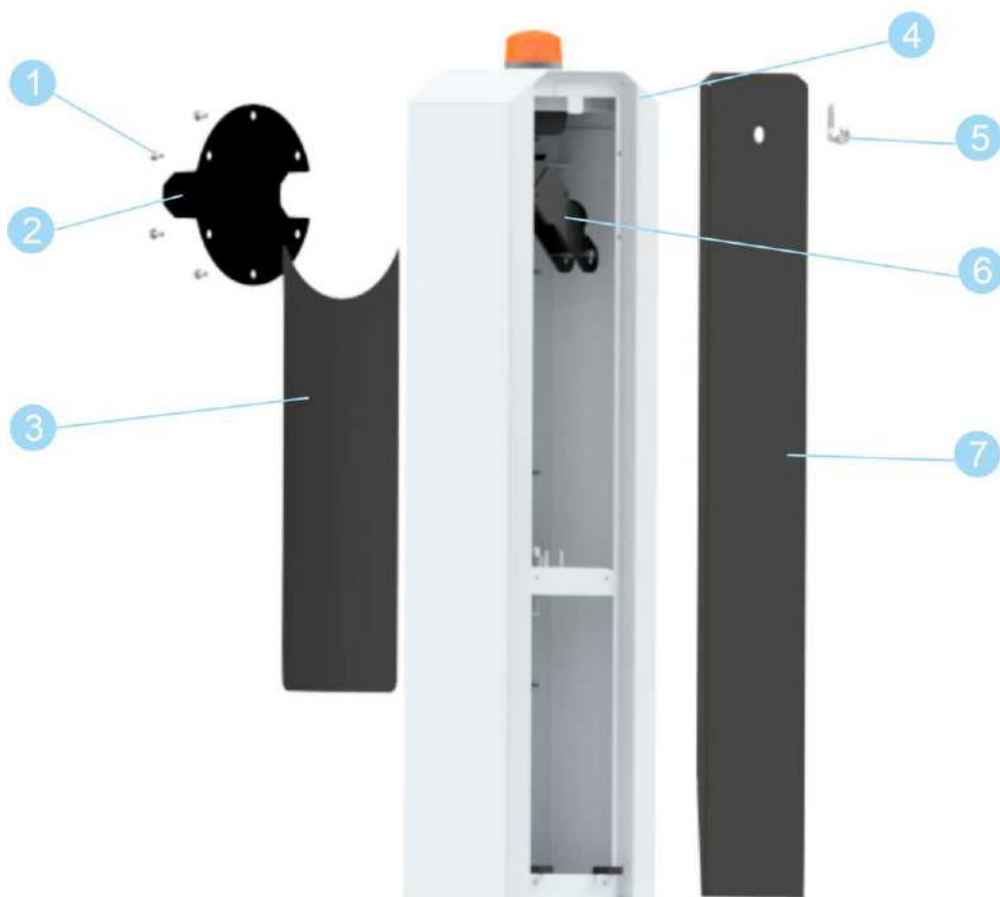
Рисунок 6.1.1 Внешний вид и состав корпуса шлагбаума
