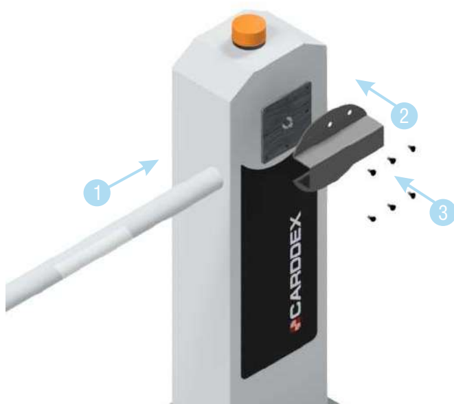
Рисунок 7.4.1 Установка стрелы на шлагбаум
