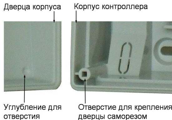
Рисунок 5. Схема «жесткого» крепления дверцы к корпусу контроллера
