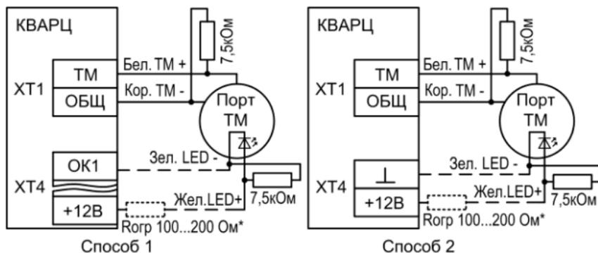
Рис.5 Схемы подключения порта Touch Memory
