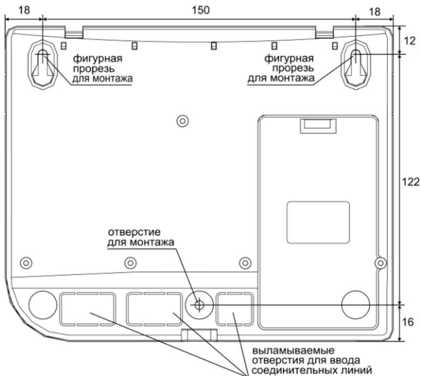
Рис.2 Задняя стенка прибора. Присоединительные размеры
