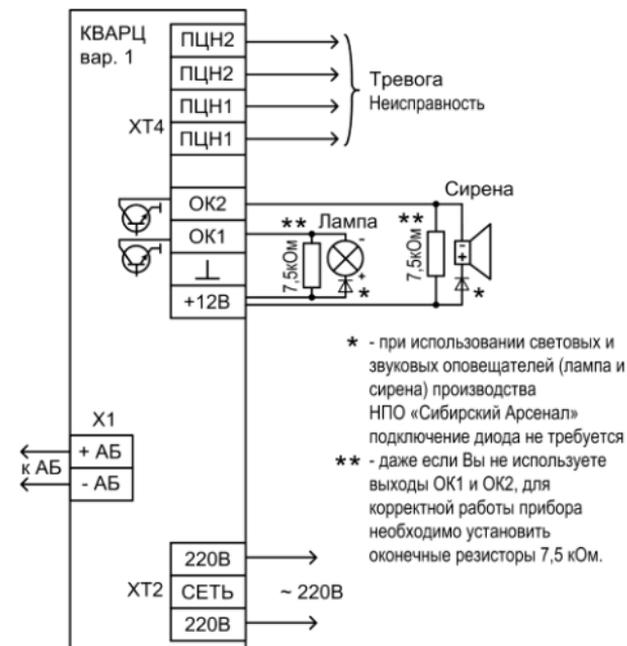
Рис.4 Схема внешних подключений
